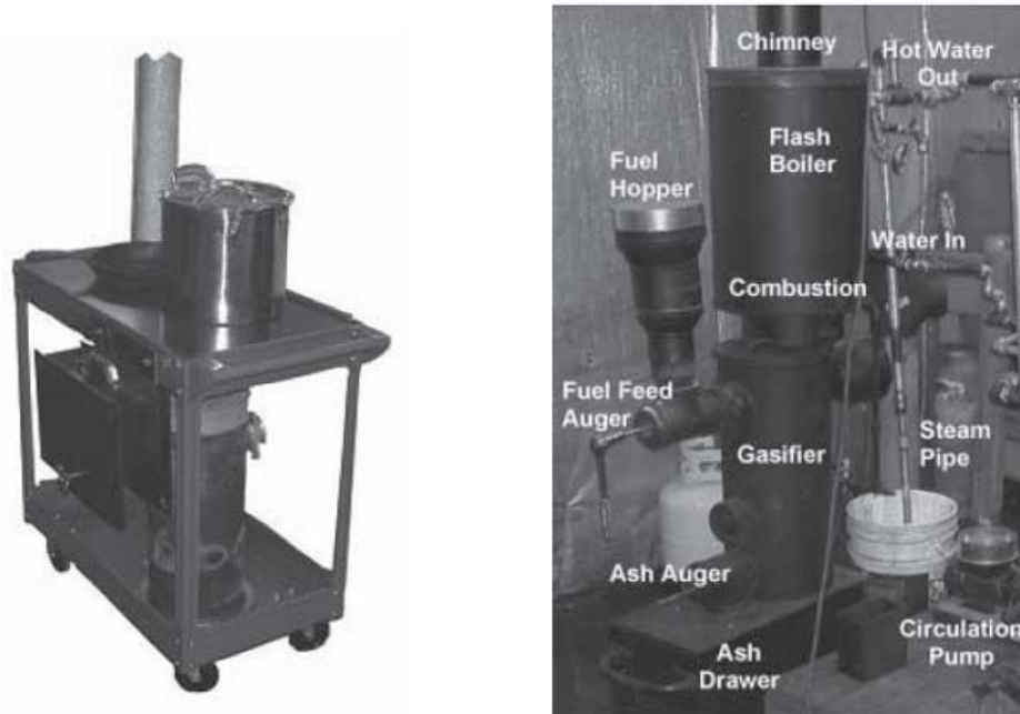
شکل ۷-۱ نمونه‌ای از یک راکتور گازی‌ساز کوچک بستر ثابت فراکشند با محفظه احتراق
