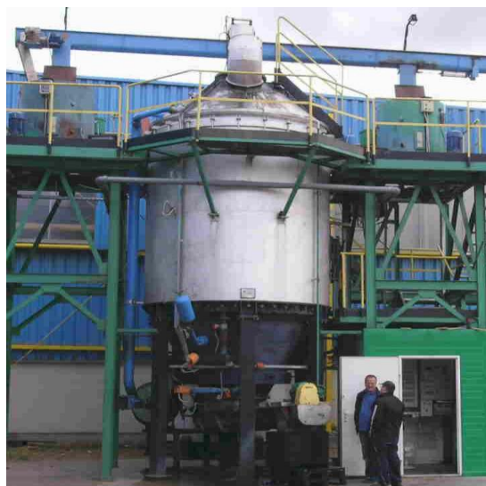
شکل ۸-۱ نمونه‌ای از راکتور بزرگ گازی‌ساز بستر ثابت فراکشند
