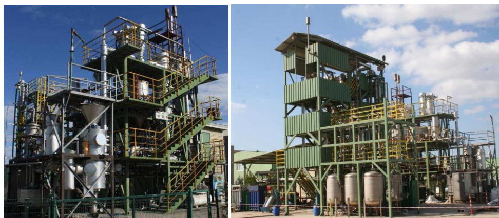
شکل ۱-۳۳ (شکل راست) گازیساز بستر سیال چرخشی در TUBITAK MRC (۱۵ مگاوات) [۴]. (شکل چپ) گازیساز بستر سیال جوشان در
